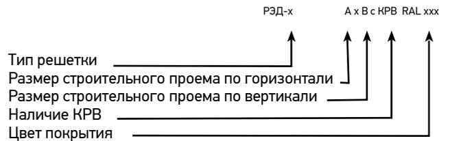
**ПРИМЕР:** 1) РЭД-Р1 300x150 с КРВ RAL9010 - вентиляционная решетка с индивидуально регулируемыми горизонтально расположенными жалюзи и условными размерами 300 мм по горизонтали и 150 мм по вертикали, с наличием клапана расхода воздуха КРВ, цвет решетки по каталогу RAL9010.
