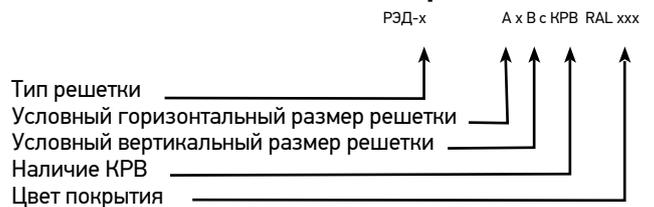
**ПРИМЕР:** 1) РЭД-ЦР1 300x150 250-315 с КРВ RAL 9016 - вентиляционная решетка для установки в круглый воздуховод с индивидуально регулируемыми горизонтально расположенными жалюзи и размером проема 300 мм по горизонтали и 150 по вертикали, для установки в воздуховоды от 250 до 315 диаметра, с наличием клапана расхода воздуха КРВ, цвет решетки по каталогу RAL9016.
